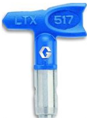
В данном примере первая цифра 5 указывает что угол распыления составляет 50 градусов, а для определения ширины полосы распыления в сантиметрах необходимо умножить первую цифру на 5:  $5 \cdot 5 = 25$  см
